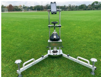
Triple-A(AAA)-Messgerät zur Bestimmung von Kraftabbau, Vertikaler Verformung und Energierückgabe (Foto: H. Nonn)
