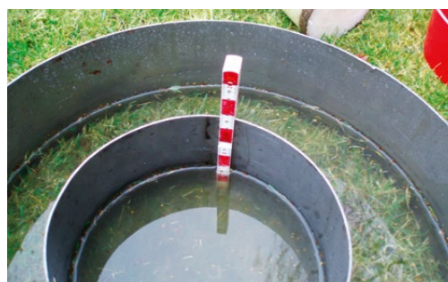
Doppelring-Infiltrometer in der Messphase (mit Meterstab zur Bestimmung der Infiltrationsmenge) (Foto: H. Nonn)
