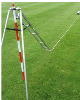
Messgerät zur Bestimmung der Ballrollstrecke (Foto: H. Nonn)
