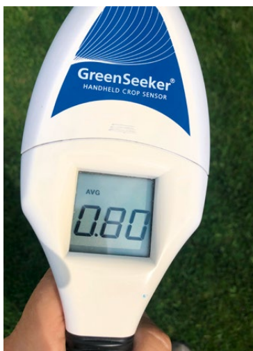
Handgeführtes Gerät zur Messung des NDVI (Foto: H. Nonn)
