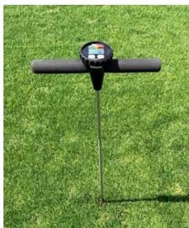
Handpenetrometer zur Bestimmung des Verdichtungsgrads (Foto: O. Schneider)
