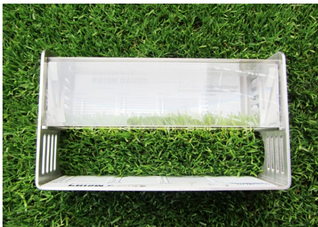
Prisma zur Bestimmung der Narbenhöhe (Foto: H. Nonn)
