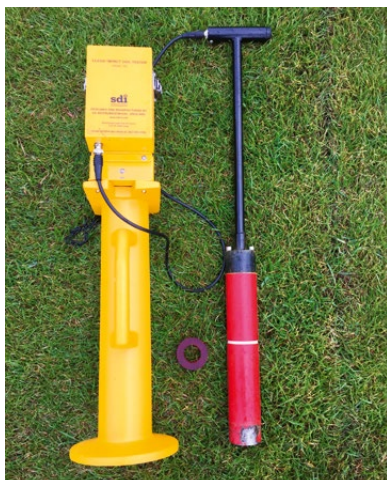
Clegg Impact Soil Tester (Clegg Hammer), Fallrohr mit Messeinheit (links) und Fallgewicht (rechts) (Foto: H. Nonn)
