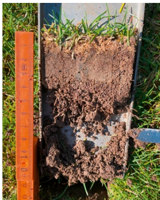
Bodenausstich mit Profilspaten und Messung der Wurzellänge und der Filzdicke (Foto: O. Schneider)
