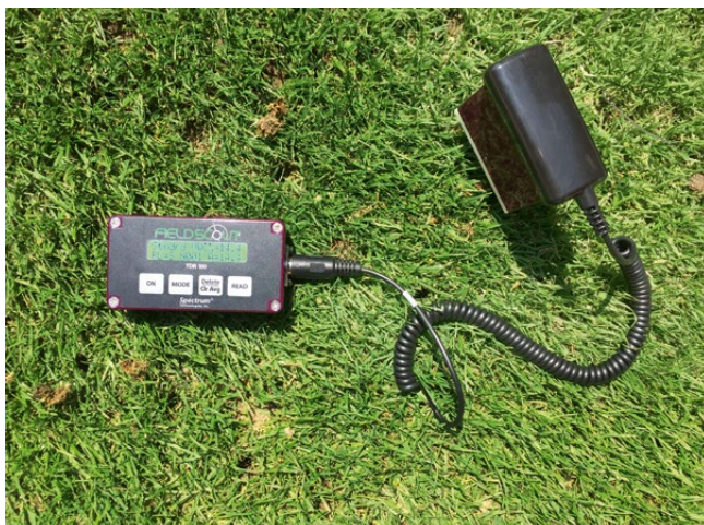
TDR-Messgerät zur Messung des volumetrischen Wassergehaltes (Foto: H. Nonn)
