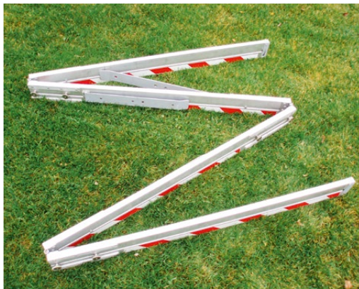
Klappbare 4-m-Richtlatte (Foto: H. Nonn)
