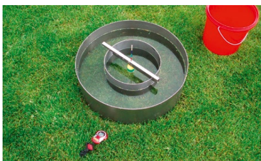
Doppelring-Infiltrometer in der Sättigungsphase (mit Schwimmer zur Bestimmung der Infiltrationsmenge) (Foto: H. Nonn)
