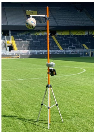
Messgerät zur Bestimmung der Ballreflexion (Foto: O. Schneider)
